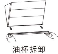
用两只手托起油杯两端底部，稍微用力往上抬和水平向外拉出，倒掉油污并清洗干净后，按相反顺序挂好油杯即可。由于油杯较长，请保持水平拆卸油杯，以免油污溢出。
